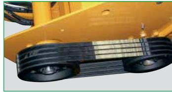
Trasmissione a cinghie dentate (4 cinghie SPB).
