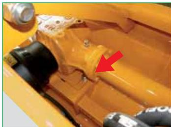
Barra stabilizzatrice dell'arcone dotata di cuscinetto (permette lo spostamento dell'arcone e l'assorbimento degli urti durante il trasporto su strada).
