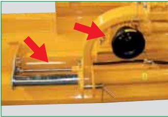
Scatola coppia conica predisposta per PTO a 540 e 1000 rpm con ruota libera.
