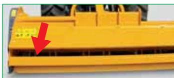
Tubolare posteriore di rinforzo della macchina. Ha anche la funzione di ancoraggio delle ruote (optional).
