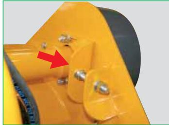
Tendicinghia a vite per il tensionamento delle cinghie.
