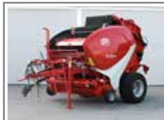
Lely RP 160 V XC17 Vorführer, Bj. '16, variable, 500 Ballen, Presskammer, Bereifung 500/55-20
