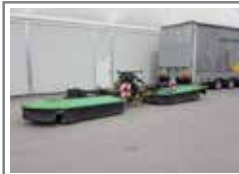
Deutz-Fahr KM 3.90 Bj. '06, Arbeitsbreite 8,5 m, Trommel, mit Einzelaushub
