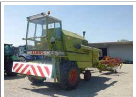
Claas Senator Bj. '69, PS/KW 125/92, Std.: 4.900, Kabine, Schneidwerk 3,60 m. Wagen
