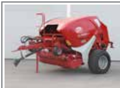
Lely RP 245 Bj. '15, 2.958 Ballen, 25 Messer, Festkammer, Netzbindung
