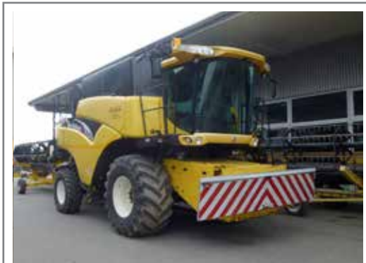
New Holland CR 960 Bj. '03, PS/kW 360/264, Std.: 3.548, Hydro, Schneidwerk 6,10 m, SW-Wagen Lg.-Nr.: 5080
