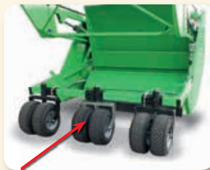
Doppia ruota posteriore a richiesta per manutenzione su terreni sportivi. Double rear wheel kit to add in case of soft turf maintenance. Roue arrière jumelée en option pour entretien de terrains de sport. Optionales Doppelradkit für bessere Gewichtsverteilung auf weichem Untergrund.
