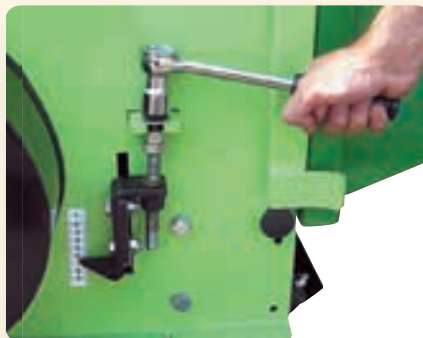
Facile millimetrica regolazione rullo. Easy millimetric roller adjustment. Réglage millimétrique du rouleau arrière. Einfachste, millimetergenaue. Höheneinstellung der Stützrolle.
