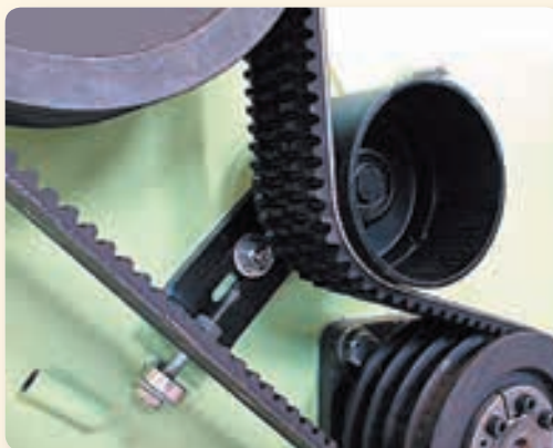
Veloce regolazione tensione cinghie dentate. Easy, quick and sturdy teeth belts tightening. Réglage simple de la tension des courroies. Schnelles und einfaches Nachspannen der Keilriemen.
