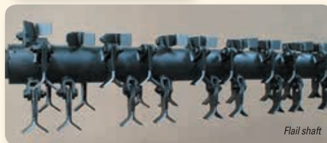
Tripla sovrapposizione dei coltelli. Flails overlapping. Superposition des fléaux. Überlappende Messer.
