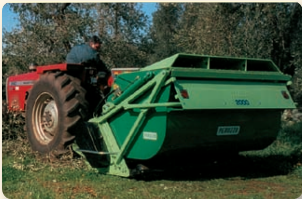
Triturazione e raccolta di potature negli oliveti. Pruning shredding and collection on olive trees fields. Broyage et ramassage de sarments d'oliviers. Mulchen und Aufnehmen von Schnittgut auf Olivenfeldern.
