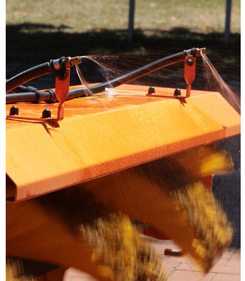
Benetzen des Bodens, um Staubeentwicklung beim Kehrvorgang deutlich zu reduzieren.
