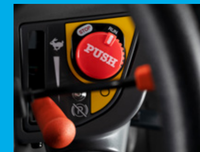
Notaus-Schalter Sofortstopp der Maschine im Gefahrenfall
