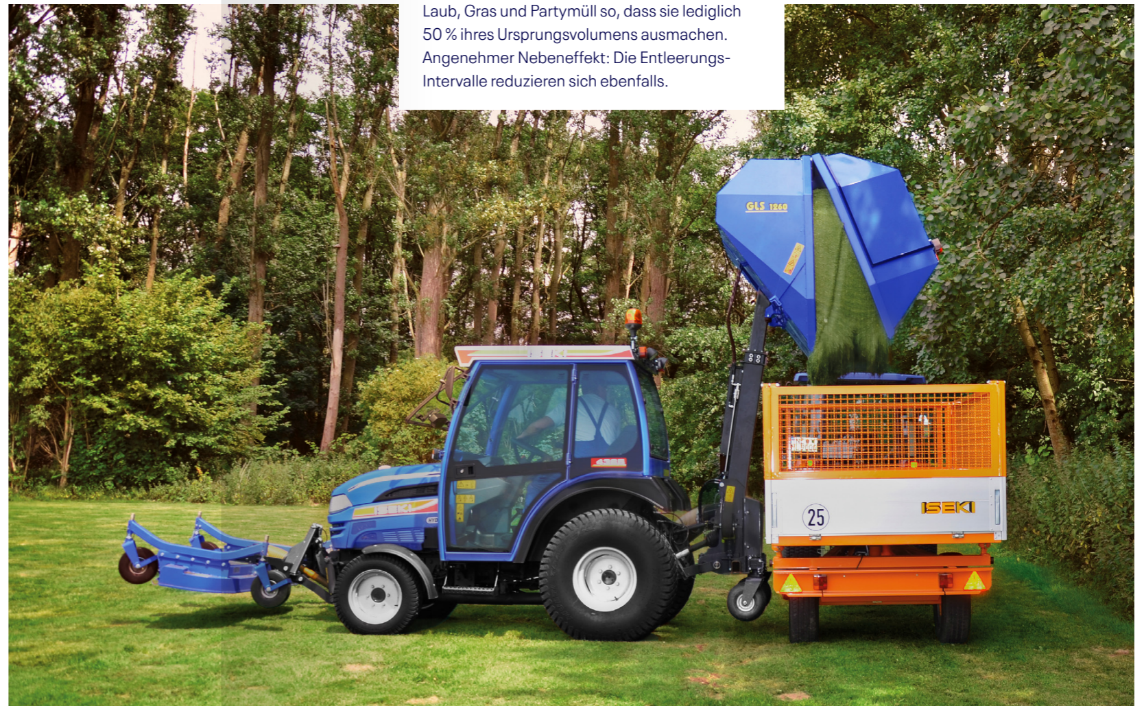
2 m Überladehöhe ermöglichen das Leeren des Behälters in Anhänger oder bereitgestellte Container.
