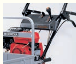
Das hydrostatische Getriebe erleichtert vieles
