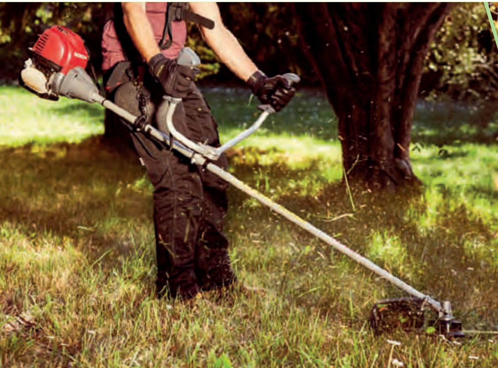
Tap-and-Go: Der halbautomatische Fadenkopf führt Schneidfaden nach, wenn er kurz auf den Boden getippt wird
