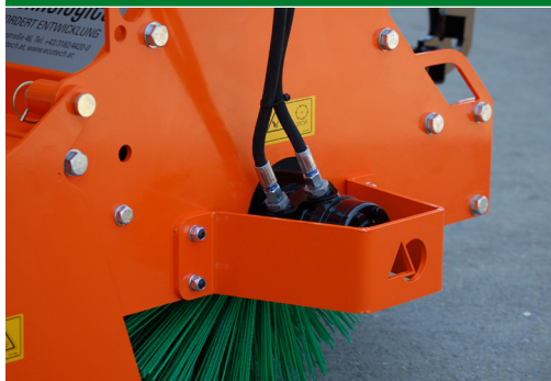
Leistungsstarker Hydromotor mit Schutzbügel
