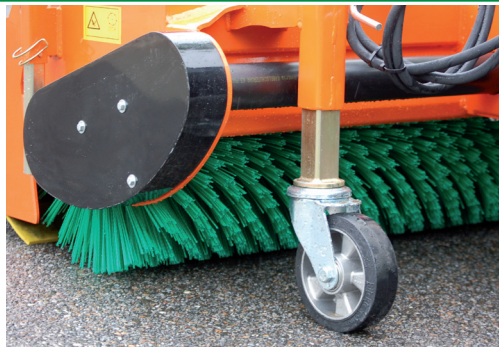
Optimales Kehrergebnis durch verstellbare Hauptbürste
