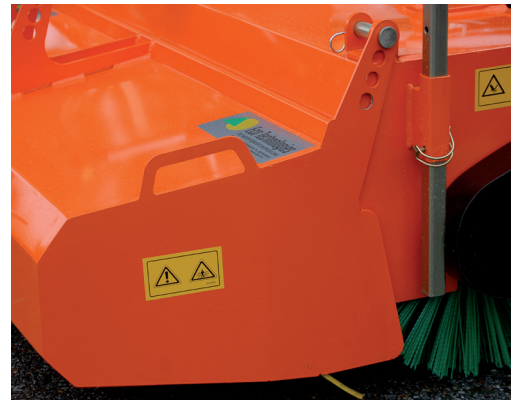
Hydraulisch entleerbarer Schmutzsammelbehälter
