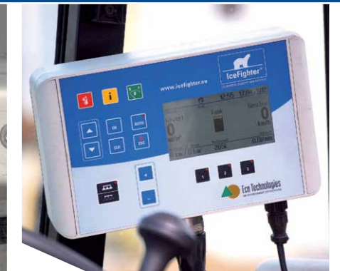
Regelungscomputer zur bequemen Bedienung aus der Fahrerkabine
