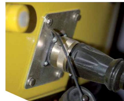
Kabinedurchgangsstecker zum bequemen Ein- und Ausstecken der Steuerung
