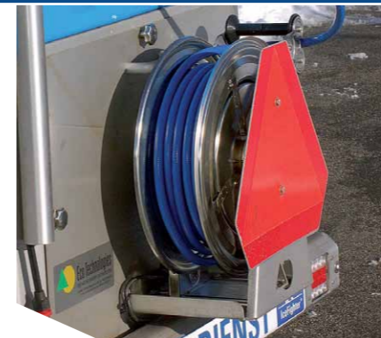
Selbstaufrollende Schlauchtrommel und Rückstrahldreieck
