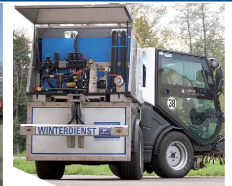
Pritschenaufbauten werden maßgefertigt ans Trägerfahrzeug angepasst
