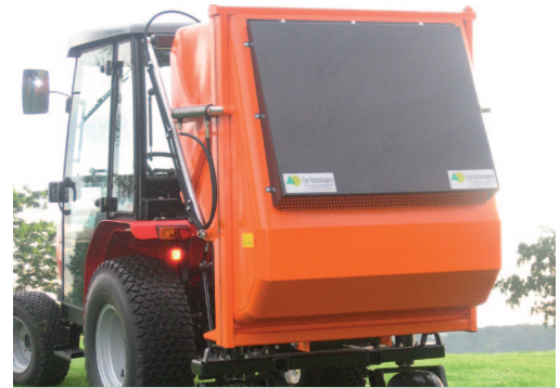
Zusätzliche Ausblasflächen für eine 100% ige Befüllung
