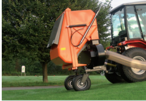
Breite Stützräder - bodenschonend
