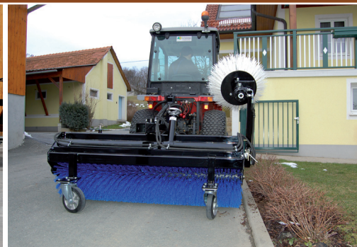
Hochklappbarer Seitenbesen für randnahes Kehren
