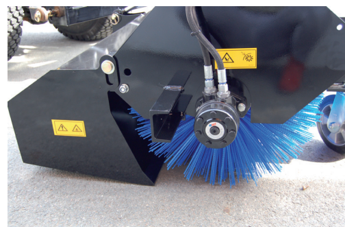
Konstant gute Schmutzaufnahme durch Bürstenzentralverstellung
