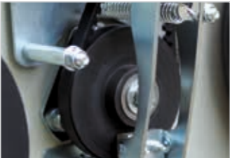
Keilriemenantrieb Ein gezahnter Keilriemen treibt die Messerwelle an. Die Kupplungsrolle ist kugelgelagert.
