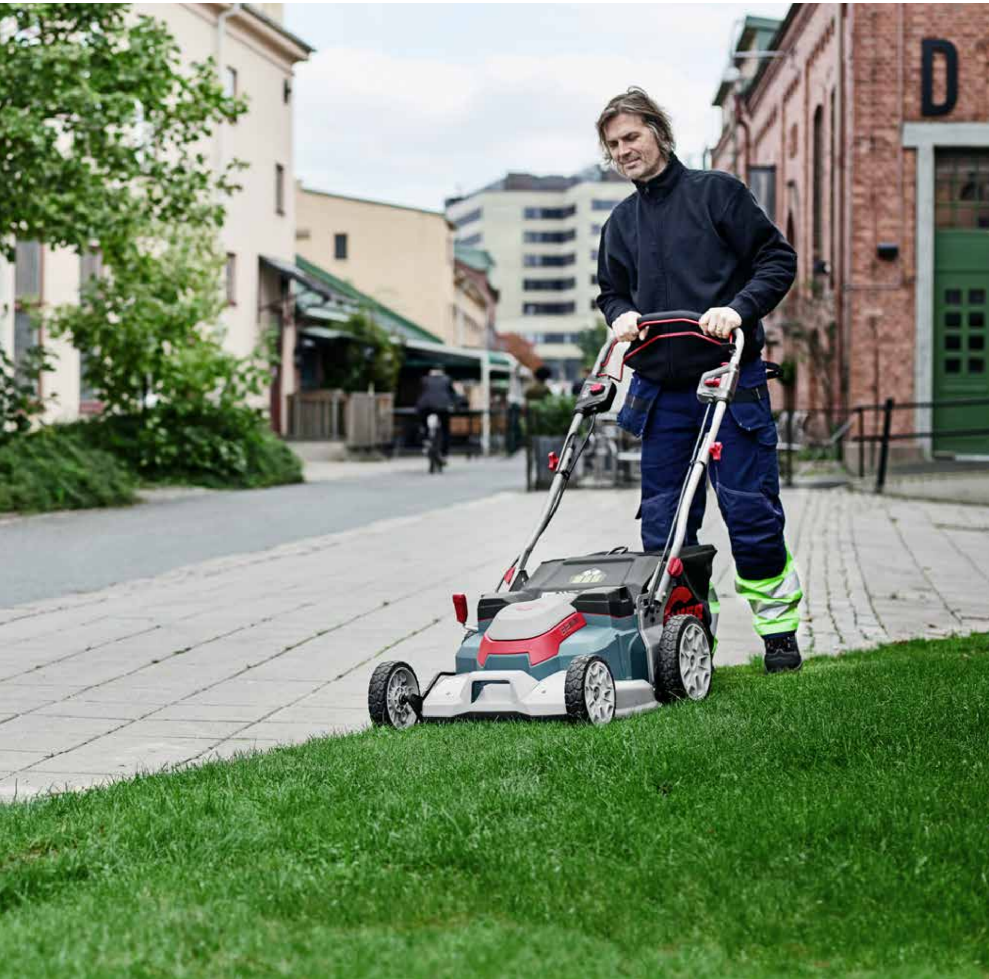
Stellen Sie ganz bequem per Handgriff die gewünschte Schnitthöhe ein – zentral in 7 Stufen zwischen 25–80 mm.
